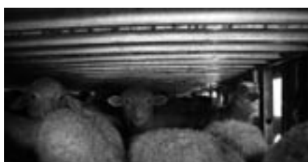
Bei so niedrigen Decken kommt es bei Hitze zu einem Wärmestau. Selbst in der neuen EU-Verordnung gibt es keine genauen Mindestmaße. Wissenschaftliche Studien fordern mindestens 15 cm über dem Kopf von Schafen. (Animals'Angels)
